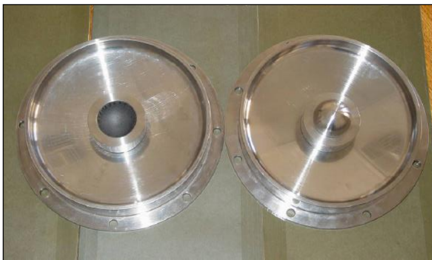
شکل ۸: اجزای داخلی جداساز اصطکاکی آونگی دوگانه
