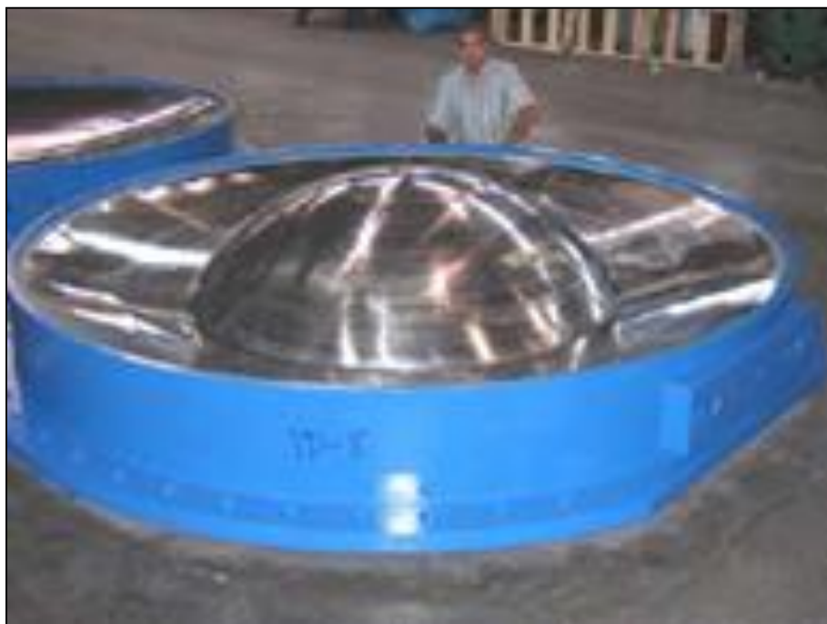
شکل ۶: جداساز اصطکاکی آونگی ساده با ظرفیت باربری قائم ۱۰۰۰۰ تن
